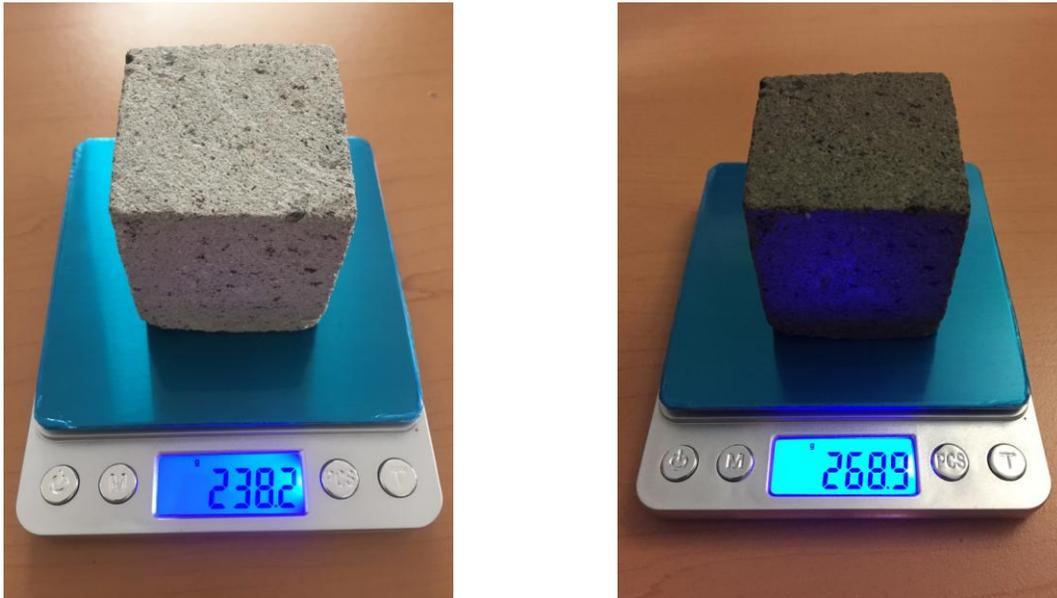
Imagen 4.- Peso de muestra seca y saturada.
